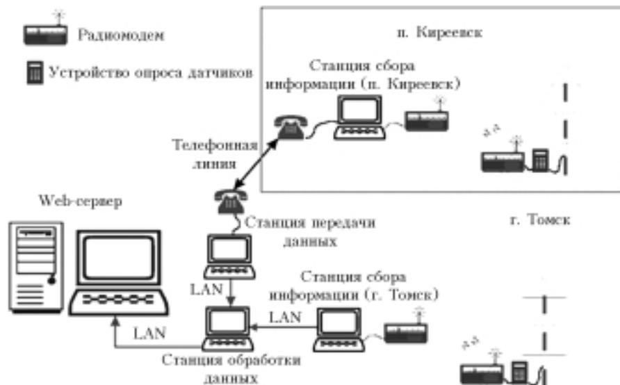
Рис. 3. Блок-схема управления измерениями и обработки информации, собранной пространственно-распределенными исследовательскими комплексами
