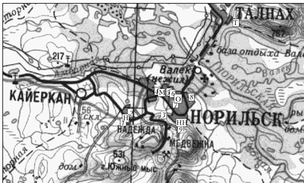
Рис. 1. Карта района с отметками мест проведения измерений в 2004 г.: О — основной стационар в гостинице; выездные пункты: 1, 4, 8; Т — наветренные или фоновые точки; Н, М, НН — под трубами заводов (комбинат «Надежда», медный завод, никелевый завод); 2, 3, 5, 6, 7, 9 — подветренные (подшлейфовые) точки
